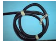
Türdichtung hinten rechts
